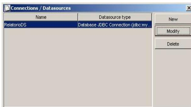
Agora é preciso definir uma conexão ativa, que será a conexão criada anteriormente. No menu Criar(build) clique em Definir a conexão ativa.
